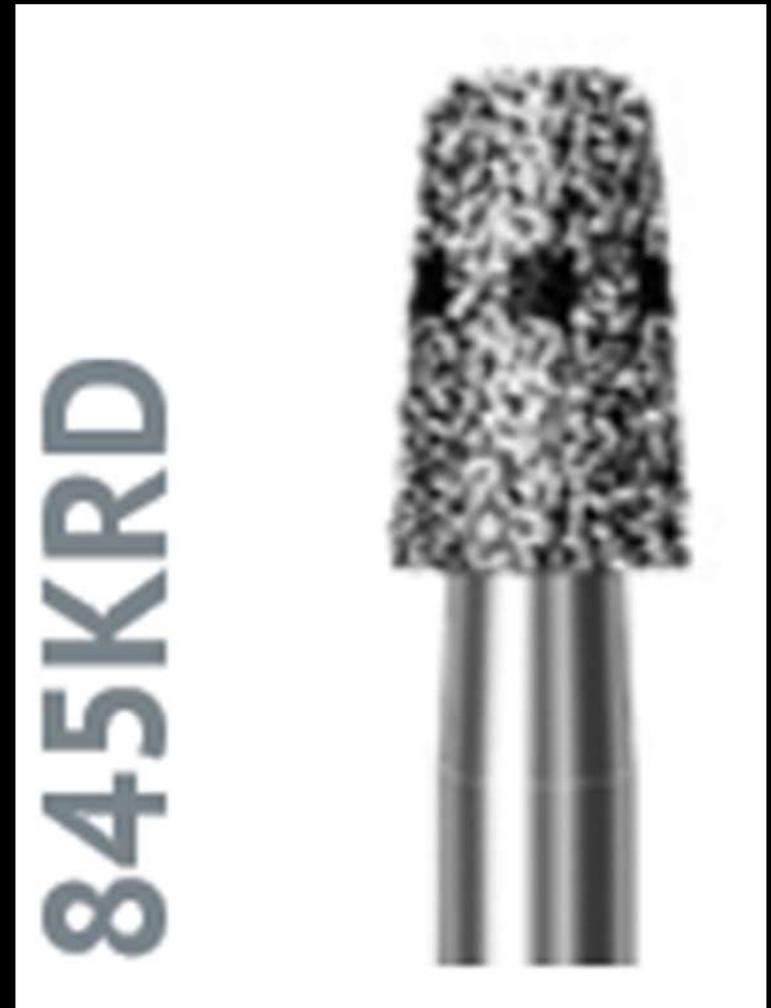
Fresa anello rosso in carburo di tungsteno da 012, conica a testa arrotondata per rifinire i monconi dopo la S6856. È una dodici lame e per questo trova posto anche nella sezione “finitura” : si adopera delicatamente su materiali a matrice resinosa come PMMA e compositi. Non “impasta”.
